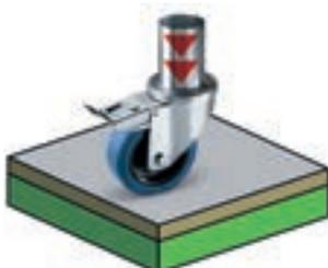
Mit Gummirädern befahrbar; Last pro Gummirad 90 kg bei 3 cm<sup>2</sup> und mehr Auflagefläche. Andere Böden sind auf Anfrage möglich.
